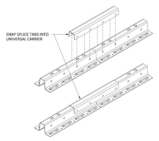
IF THE DESIRED CARRIER LENGTH EXCEEDS THE MAXIMUM OF 16'-0", USE A UNIVERSAL CARRIER SPLICE TO CONNECT THE FACTORY CARRIER ENDS.
